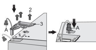
Posizionare lo sportello superiore nella posizione corretta e tenerla ferma. Far passare il connettore (A) attraverso il foro del cardine superiore (3) e fissarlo con le viti (2). Collegare il connettore (A).
