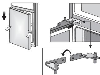
Posizionare lo sportello inferiore sul cardine inferiore e tenerla ferma. Ruotare il cardine centrale di 180°, posizionarvi la rondella e sistemare il cardine nella posizione corretta in modo da poter fissare lo sportello inferiore al suo posto.
