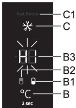
Quando la temperatura è troppo alta, suona l'allarme (tono interrotto), e sul display **B3** lampeggia **HI**, allo stesso tempo si illumina il simbolo del vano dell'apparecchio in cui la temperatura è troppo alta (**B1** o **B2**).
