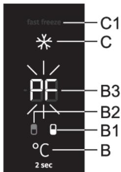
Se l'apparecchio si riscalda a una temperatura di allarme durante l'interruzione di corrente, l'allarme di alta temperatura si riattiva al ritorno della corrente elettrica. Viene emesso un allarme acustico e **PF** lampeggia sul display **B3**.
