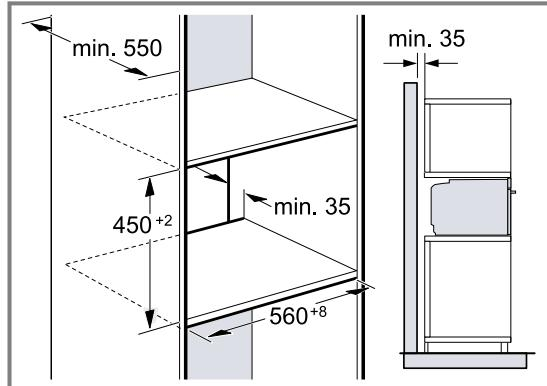
lo zoccolo o montare una griglia di ventilazione. Prestare attenzione a che lo scambio di aria sia conforme allo schizzo.
