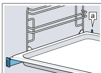
**Nota:** Spingere indietro con una leggera pressione le guide di estrazione nel vano cottura.
