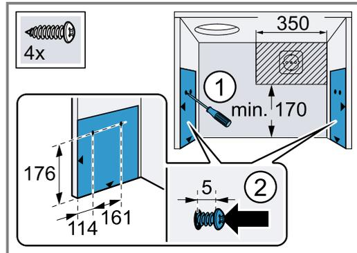
8. Stringere le 4 viti fornite in dotazione per la staffa di supporto fino a 5 mm di distanza.
