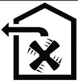
L'aria non deve essere deviata in un camino che viene utilizzato per lo scarico di gas di apparecchi che bruciano gas o altri combustibili (questo non vale per apparecchi a ricircolo d'aria).
