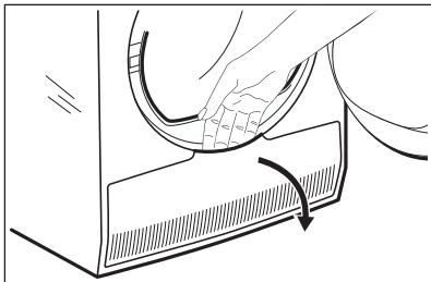
3. Ruotare le leve per sbloccare il coperchio del condensatore.
