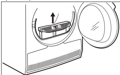
2. Aprire la copertura del condensatore.
