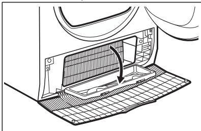
5. Se necessario, togliere la lanugine dal condensatore e dal suo alloggiamento. È possibile utilizzare un aspirapolvere con un accessorio a spazzola.
