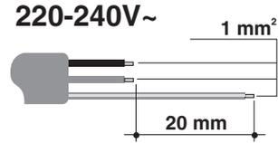
Utilizzare un cavo **tripolare 3 x 1 mm<sup>2</sup>**.
