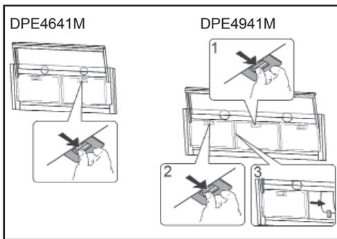
Az aktív szén-szűrő se nem tisztítható és se nem újítható fel, ezért kb. 4 havonta (illetve intenzív használat esetén sűrűbben) cserélni kell.
