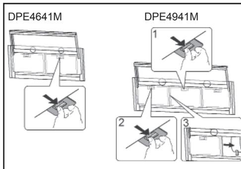
фильтр деревянного угля не подходит для очистки, не может быть обновлен, а должен заменяться приблизительно каждые 4 месяца использования или чаще в случае интенсивного использования.
