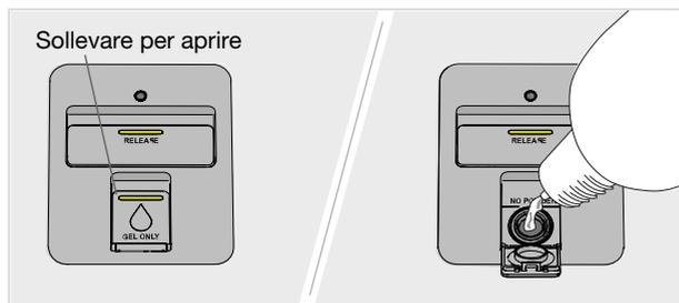
1. Aprire il coperchio del cassetto dosaggio automatico per il detersivo in gel per lavastoviglie.
