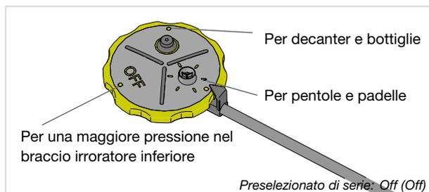
Lasciare aperte le power zone per un maggiore flusso d'acqua nelle posizioni in cui sono state collocate, ad esempio, pentole e padelle o decanter e bottiglie. Chiudere le power zone della lavastoviglie per ottenere una maggiore pressione di irrorazione nel braccio irroratore inferiore.
