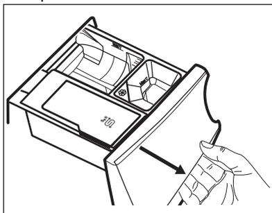
2. Versare il detersivo in polvere nello scomparto [III]. Se si utilizza detersivo liquido, consultare la sezione "Riempire con detersivi liquidi".
