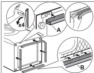
**i** Fissare le barriere insonorizzanti a una temperatura ambiente.
