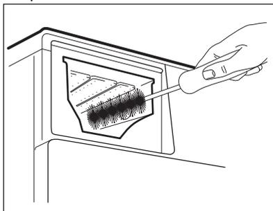
6. Inserire il cassetto del detersivo nei binari della guida, quindi chiuderlo. Avviare il programma di risciacquo senza indumenti all'interno del cesto.
